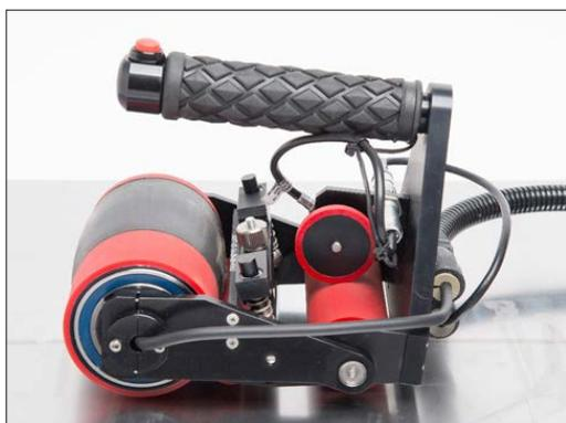
Роликовый преобразователь для контроля плоских поверхностей
