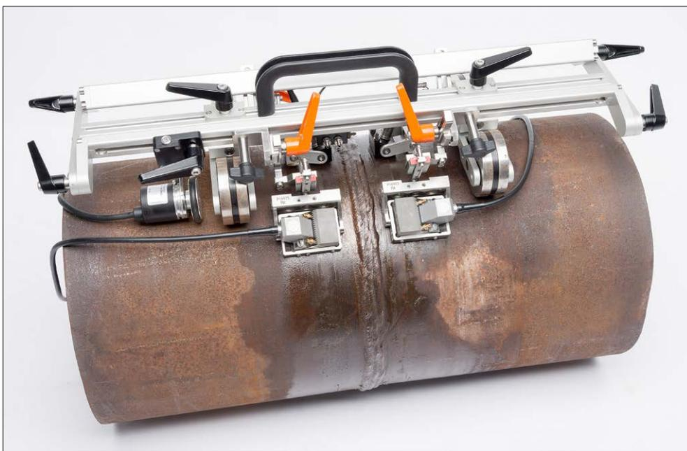
Пример механизма для ручного контроля кольцевых сварных швов трубы с колесным энкодером и держателями для 2-х преобразователей на фазированных решетках и 2-х преобразователей TOFD
