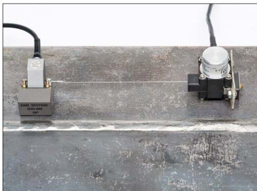
Проволочный энкодер с магнитной ножкой, длина сканирования 500 мм, 40 импульсов / мм, Артикул: 1885.002
