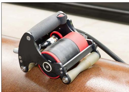
Роликовый преобразователь для продольного контроля прутков и труб
