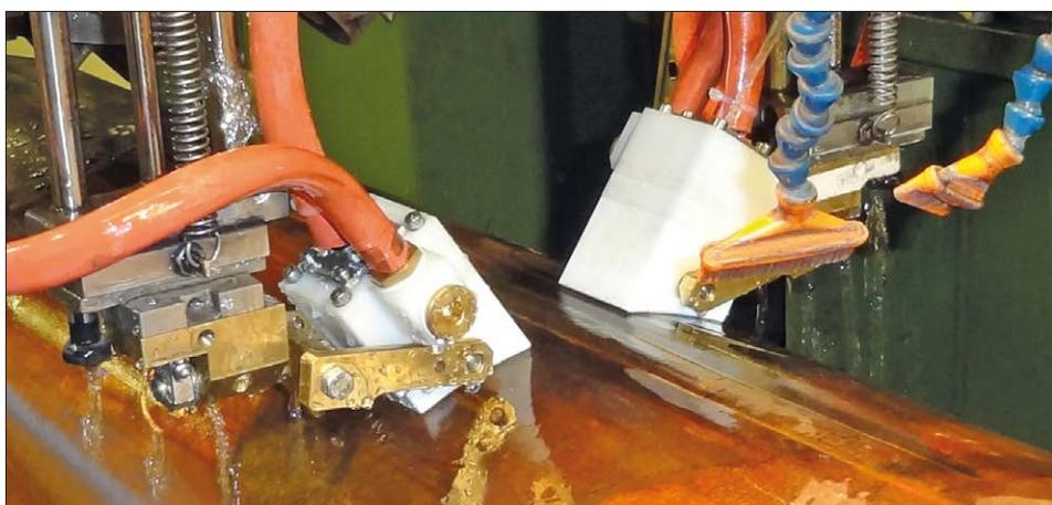
Водное сопло для преобразователей 1598.666 и 1598.649 с индивидуально подобранным радиусом для автоматизированного контроля продольных сварных швов
