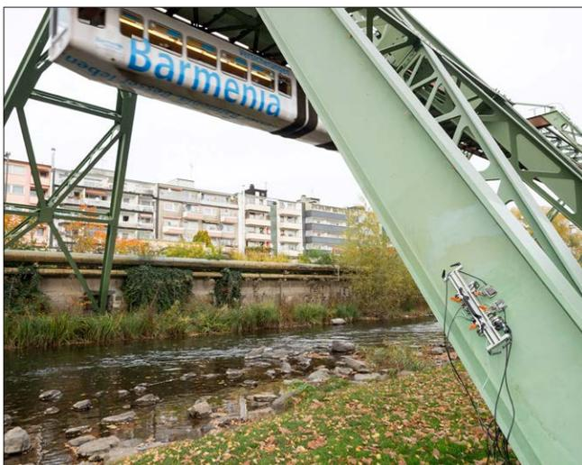
Контроль сварных швов на опоре знаменитой Вуппертальской подвесной железной дороги
