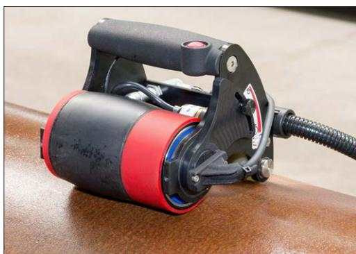
Роликовый преобразователь для кругового контроля прутков и труб
