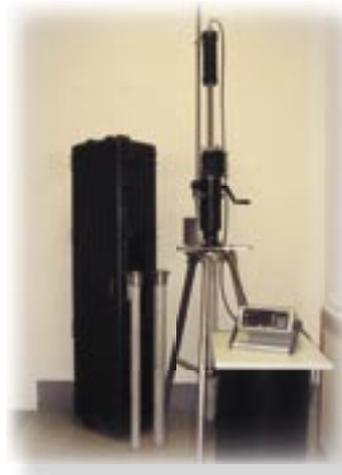
Установка ПАУЗК стоек крышек аппаратов предназначена для проведения контроля с целью выявления эксплуатационных нарушений сплошности металла продольного и поперечного типа, а также фиксации участков изделий с недопустимой толщиной (выходящей за минусовой допуск).
