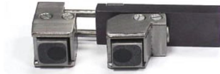
Устройство УН-1 предназначено для УЗК нахлесточных сварных соединений с целью обнаружения в сечении сварного шва недопустимых несплошностей. Устройство состоит из двух ультразвуковых преобразователей П121 - 5 - 45° и механического приспособления, имеющего направляющую и фиксирующий винт.
