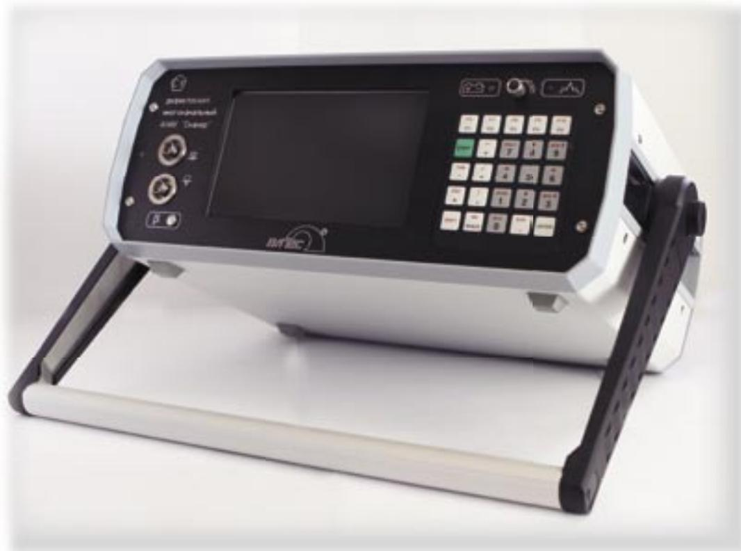
Переносной многоканальный дефектоскоп-толщиномер АУИУ «СКАНЕР» предназначен для создания на его основе небольших участков автоматизированного высокоскоростного ультразвукового контроля в технологическом потоке производства различных изделий. В зависимости от задачи контроля дефектоскоп может иметь до 9 независимых каналов.
