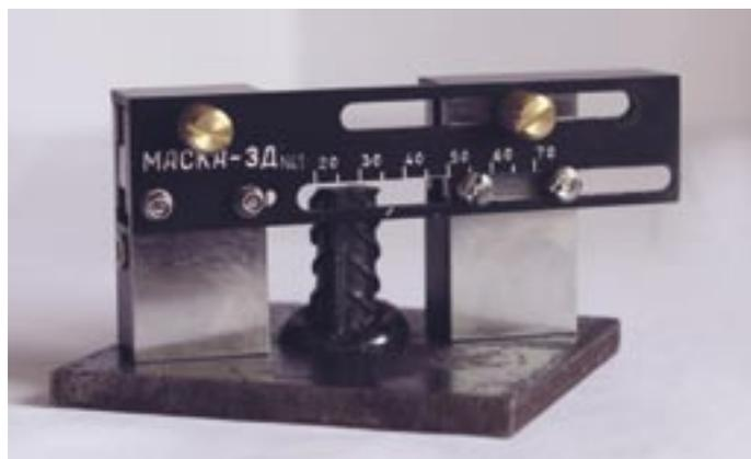
Устройство механическое МАСКА-ЗД предназначено для проведения неразрушающего ультразвукового контроля качества сварных соединений закладных деталей, сваренных в тавр под слоем флюса, в среде углекислого газа и ручной дуговой сваркой.
