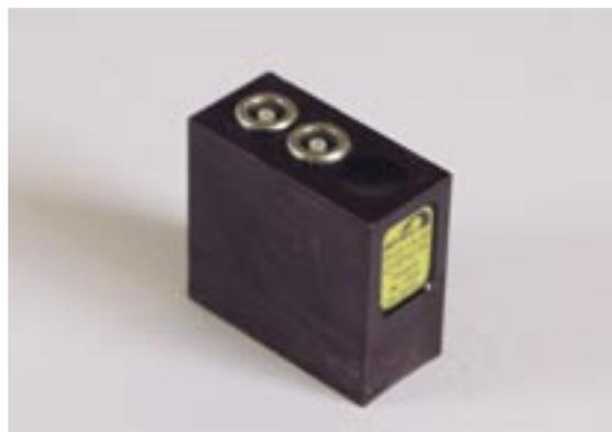
Для УЗК сварных соединений полиэтиленовых трубопроводов, выполненных контактной сваркой, применяют ультразвуковые специализированные преобразователи типа П122-1,8 «Дуэт» и «Тандем», которые за сравнительно короткий срок их применения хорошо зарекомендовали себя в полевых и производственных условиях.
