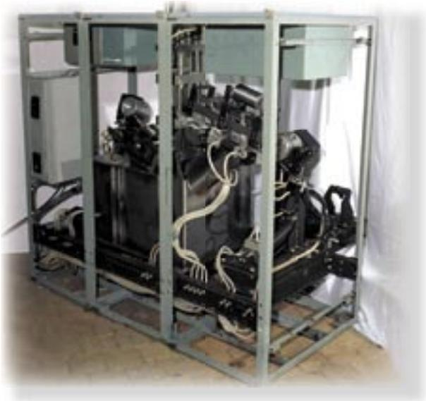
Установка АУЗК предназначена для обнаружения поверхностных и внутренних дефектов в материале автомобильных поршней в процессе их серийного изготовления.
