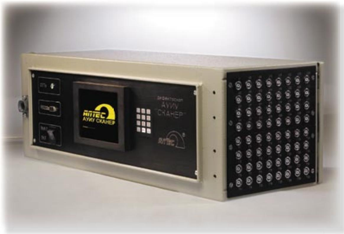
Многочанальный дефектоскоп-толщиномер АУИУ «СКАНЕР» предназначен для создания на его основе автоматизированных линий высокоскоростного ультразвукового контроля в технологическом потоке производства различных изделий: труб, листов, дисков, колец, валов, поршней и т.п., заготовок металлоконструкций и других изделий. В зависимости от задачи контроля дефектоскоп может иметь до 32 независимых каналов.
