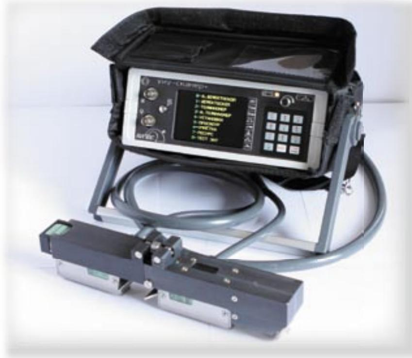
Малогабаритная ультразвуковая измерительная установка серии «СКАНЕР+» – модель «СКАРУЧ» (УИУ «СКАРУЧ») предназначена для оперативного обнаружения и определения характеристик дефектов в сварных соединениях и основном металле трубопроводов, сосудов и металлоконструкций с толщиной стенки 4 ... 60 мм и проведения толщинометрии изделий толщиной до 100 мм.
