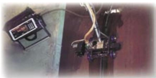
Установка полуавтоматизированного ультразвукового контроля предназначена для дефектоскопии сварных швов в цеховых условиях. Применяется также для перепроверки результатов АУЗК.
