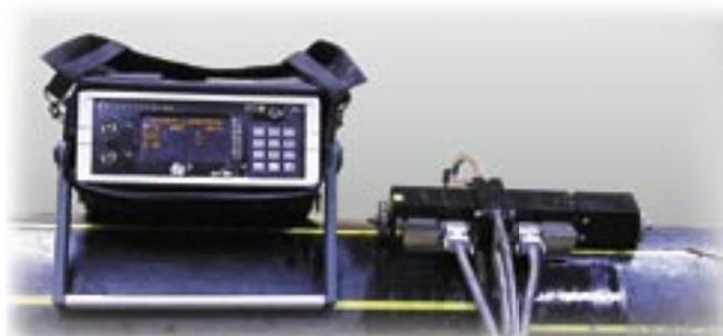
Установка ПАУЗК предназначена для дефектоскопии сварных соединений полиэтиленовых трубопроводов в полевых условиях.
