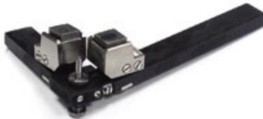
Устройство УП-1 предназначено для УЗК перекрестий (пересечений) сварных швов или обнаружения поперечно-ориентированных дефектов в стыковом сварном соединении. Устройство состоит из двух ультразвуковых преобразователей П121-5-
