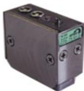
Раздельно-совмещенный наклонный ультразвуковой преобразователь СП5-75KYS предназначен для проведения контроля качества стыковых сварных соединений труб, сосудов и металлоконструкций с толщиной стенки 2,5...12 мм.
