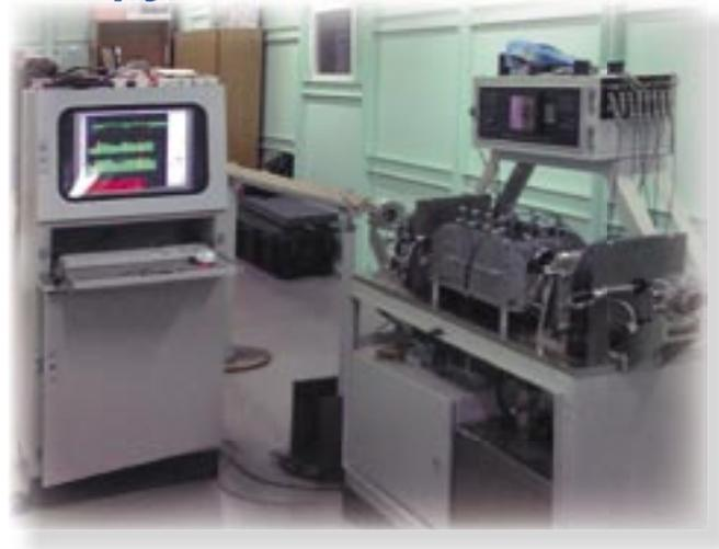
Автоматизированная ультразвуковая измерительная установка серии «СКАНЕР» (модель № 6.03) предназначена для проведения неразрушающего контроля стальных бесшовных холодно и теплodeформированных труб марок сталей 12X18H10T, 08X18H10T, 06X18H10T и других нержавеющей марок сталей диаметром 5...90 мм и толщиной стенки 0.2...10 мм в технологическом потоке производства труб.
