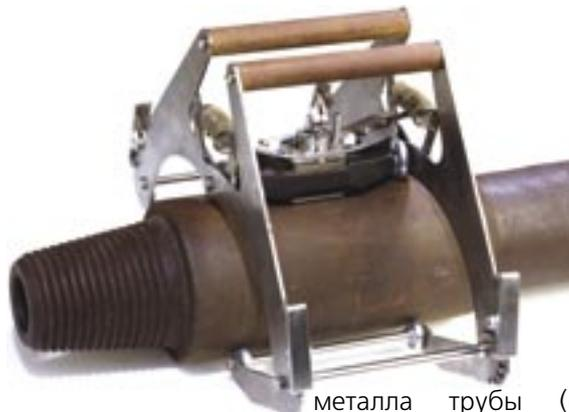
Устройство механическое для УЗК бурильных труб диаметром 60...168 мм предназначено для обнаружения в сечении бурильной трубы недопустимых дефектов и коррозии, а также для выявления в резьбовой части замковых соединений трещинообразных дефектов.
