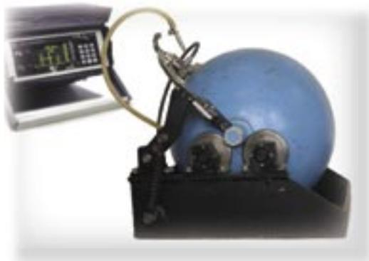
ПАУЗК ведётся по покрашенной поверхности баллонов. В процессе контроля постоянно ведётся слежение за уровнем акустического контакта. Минимально обнаруживаемые дефекты сварных соединений - 0,2 мм.
