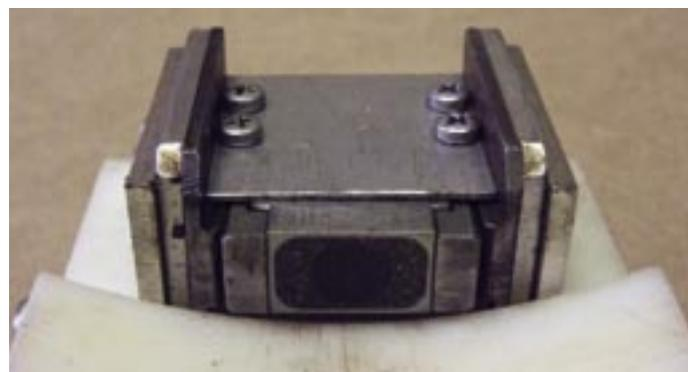
Проведение ручного УЗК резьбовой части замковых соединений бурильных труб осуществляется специализированными преобразователями щелевого контакта с использованием радиусной опоры.
