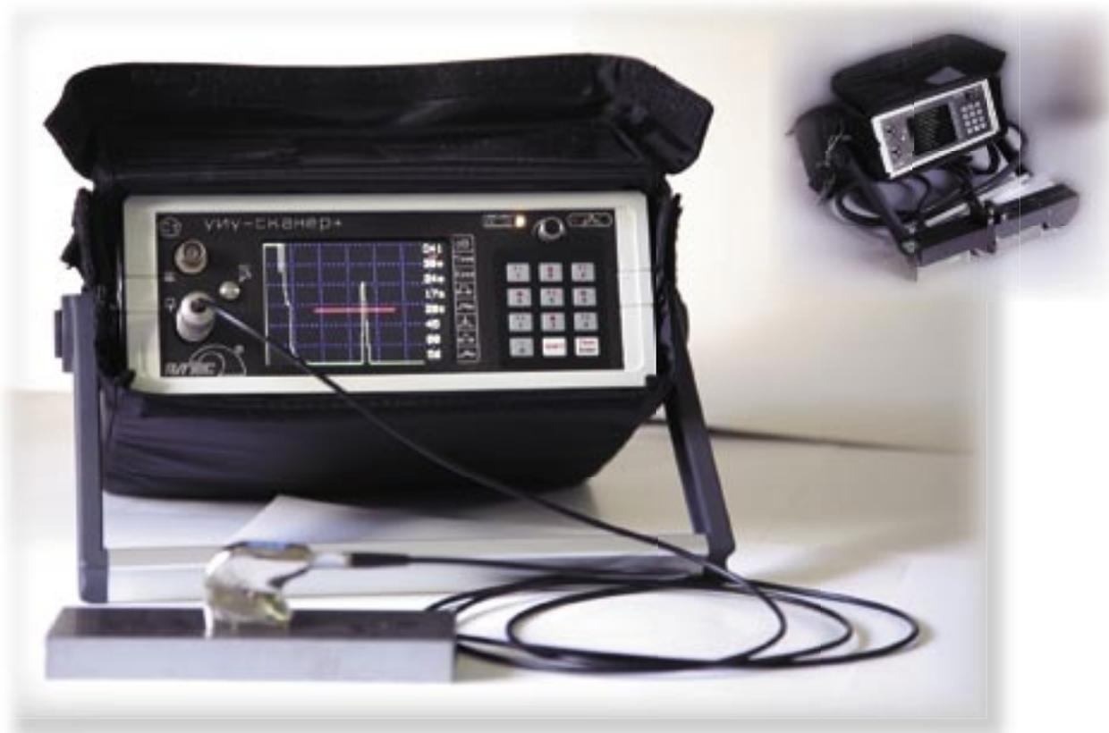
Малогабаритный восьмиканальный дефектоскоп серии «СКАНЕР+» – модель «СКАРУЧ» (УИУ «СКАРУЧ») предназначена для оперативного обнаружения и определения характеристик дефектов в сварных соединениях и основном металле трубопроводов, сосудов и металлоконструкций. УИУ «СКАРУЧ» позволяет проводить неразрушающий контроль качества металлов, полиэтилена, пластмасс, керамики.
