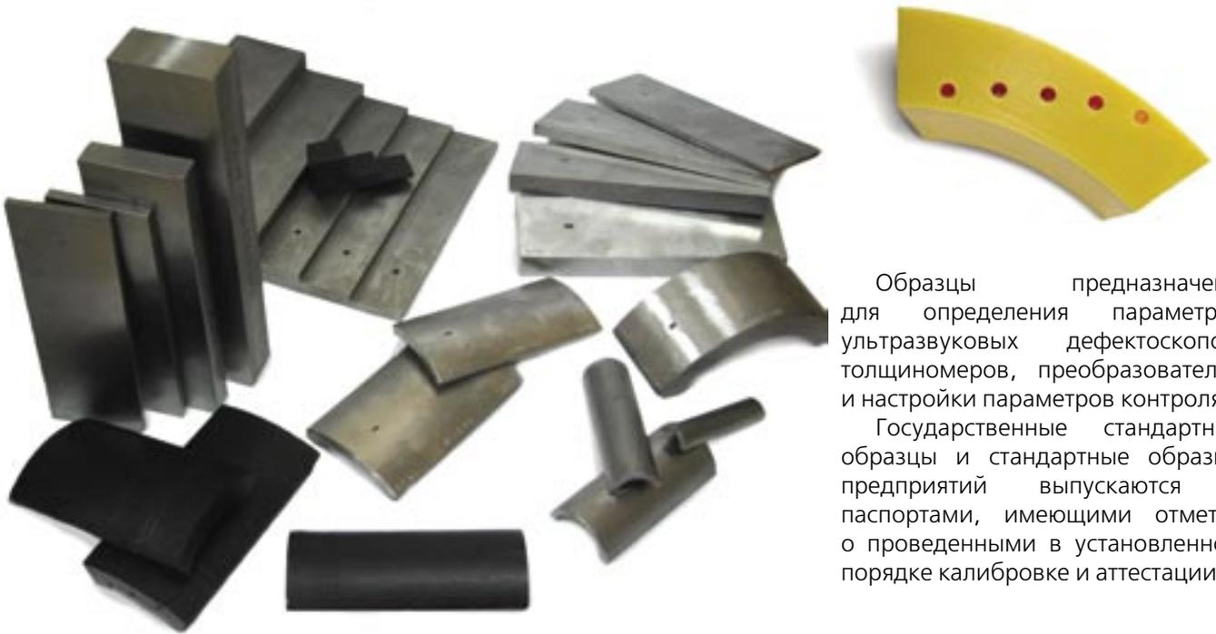
Образцы предназначены для определения параметров ультразвуковых дефектоскопов, толщиномеров, преобразователей и настройки параметров контроля.
