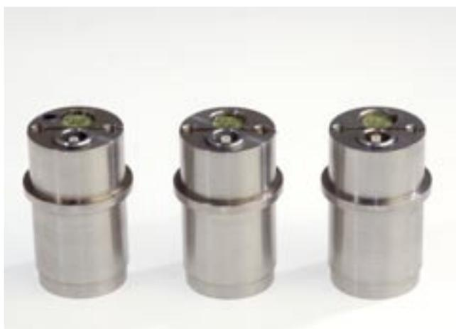
Преобразователи щелевого контакта предназначены для ультразвуковой дефектоскопии, толщинометрии сварных соединений и основного металла труб, сосудов, резервуаров, ёмкостей, листов и др. изделий в щелевом варианте контроля с использованием в качестве контактной жидкости воды или незамерзающих жидкостей.
