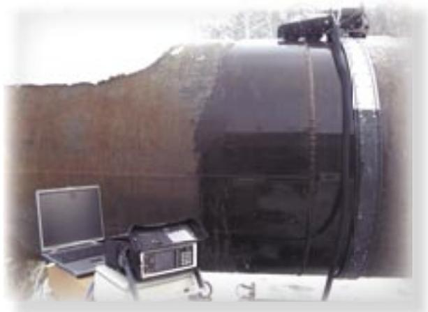
Установка предназначена для проведения автоматизированного УЗК сварных швов и основного металла магистральных нефте-газопроводов в цеховых и полевых условиях с целью обнаружения недопустимых дефектов в кольцевых швах трубопроводов согласно требованиям:
