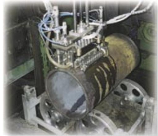
Автоматизированная ультразвуковая измерительная установка серии «СКАНЕР» (модель № 7.04) предназначена для контроля концов труб с целью обнаружения расслоений, продольно и поперечно ориентированных дефектов по всей толщине стенки стальных бесшовных горячекатаных труб диаметром 159...426 мм и толщиной стенки 6 ... 40 мм в технологическом потоке производства труб. Контроль ведется с автоматической фиксацией и расшифровкой результатов контроля.
