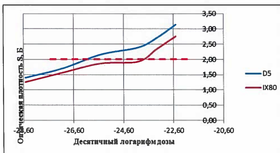
в) изменение оптической плотности радиографических пленок D5, IX80.
