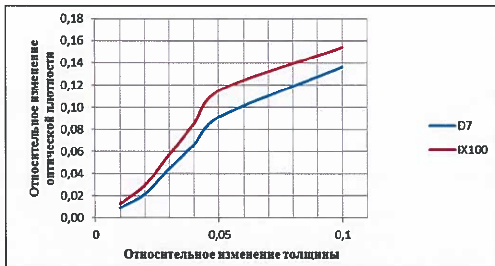
г) относительное изменение оптической плотности радиографических пленок D7, IX100.
