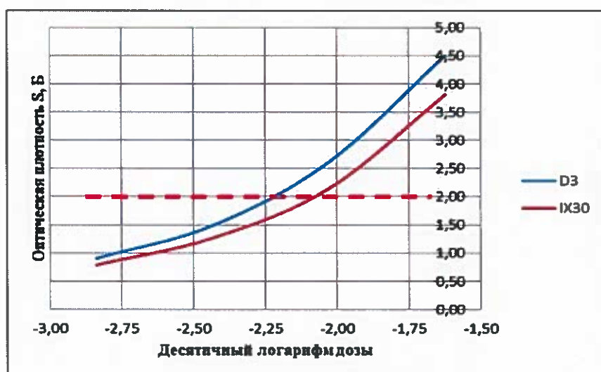
а) изменение оптической плотности радиографических пленок D3, IX50.
