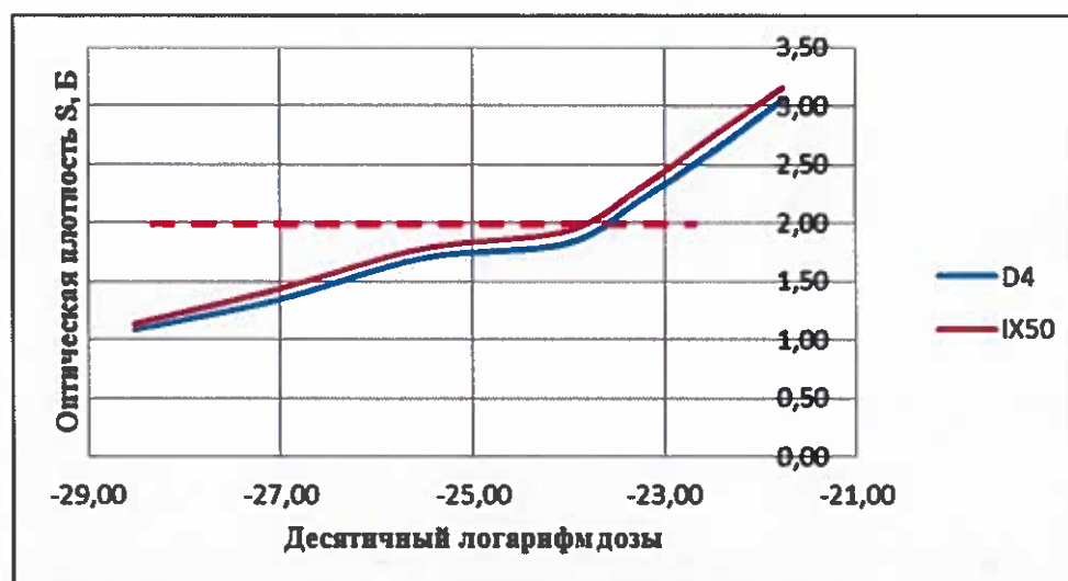
б) изменение оптической плотности радиографических пленок D4, IX50.
