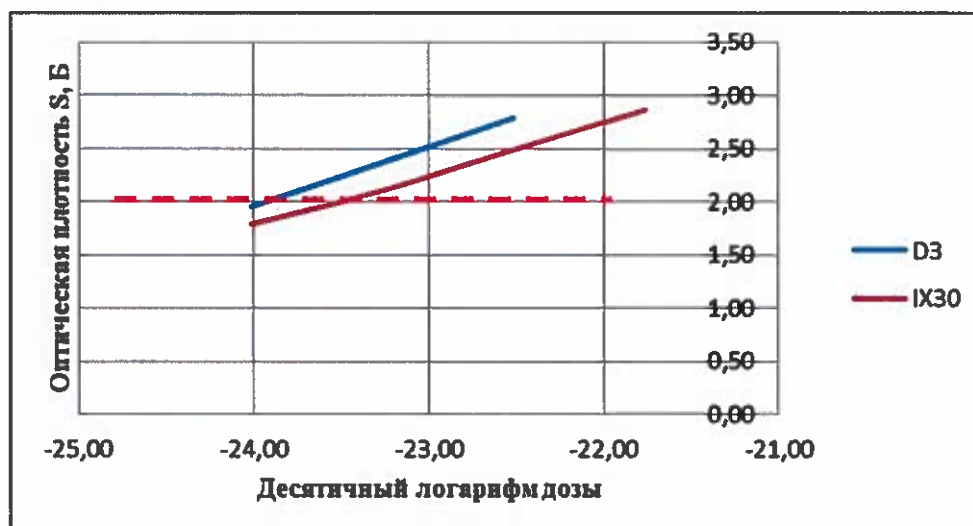
а) изменение оптической плотности радиографических пленок D3, IX30.
