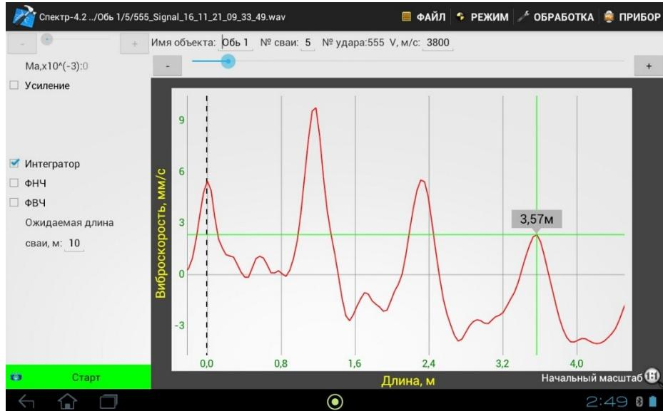
Рисунок 6.3 - Определение длины сваи
