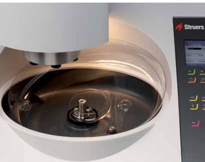
*Вращатель образцов поворачивается на 180°.
