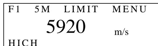
Нажмите на клавишу VEL для ввода скорости звука с помощью клавиш  $\Delta$  и  $\nabla$       Значение скорости звука после регулировки
