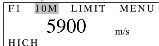
При каждом нажатии на клавишу ENTER будут последовательно отображаться установочные частоты преобразователя 2M (2 МГц), 5M (5 МГц) и 10M (10 МГц).
