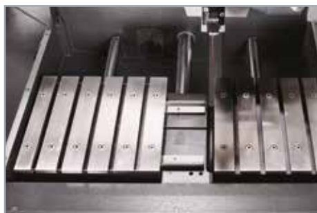
Автоматический стол*с перемещением по оси x
