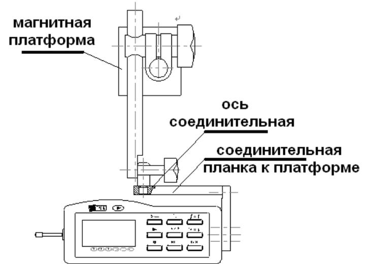
Рис. 3.4 Установка прибора на магнитной измерительной плите
