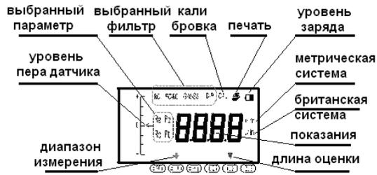
Рис. 1.3.3 Обозначение символов на дисплее
