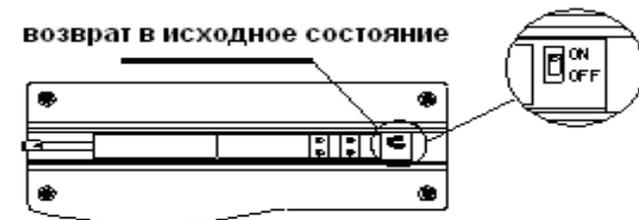
Рис. 6.1. Выключатель питания
