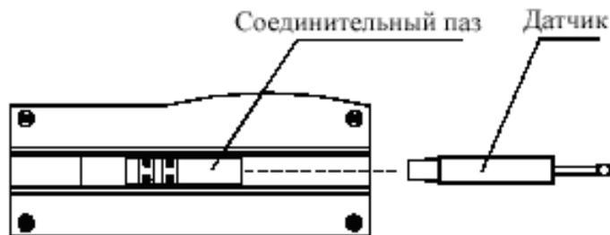
Рис. 1.4.1 Подсоединение и отсоединение датчика
