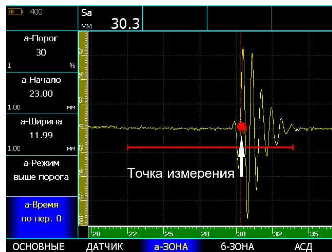
Рис.3-5 Измерение времени прихода сигнала 'по переходу через ноль'
