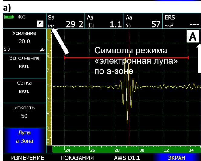
б) Рис.4-1 Работа в режиме 'электронная лупа'. а) обычный режим, б) увеличение сигнала а-зоне
