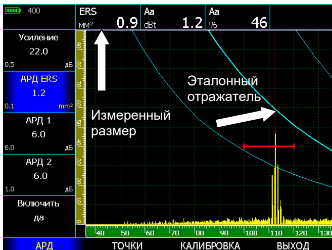
Рис.6-5 Вычисление эквивалентной площади отражателя
