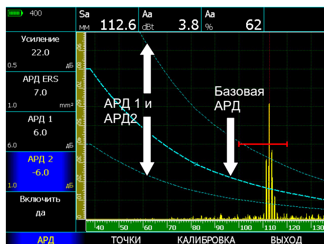
Рис.6-3 Установка дополнительных линий АРД
