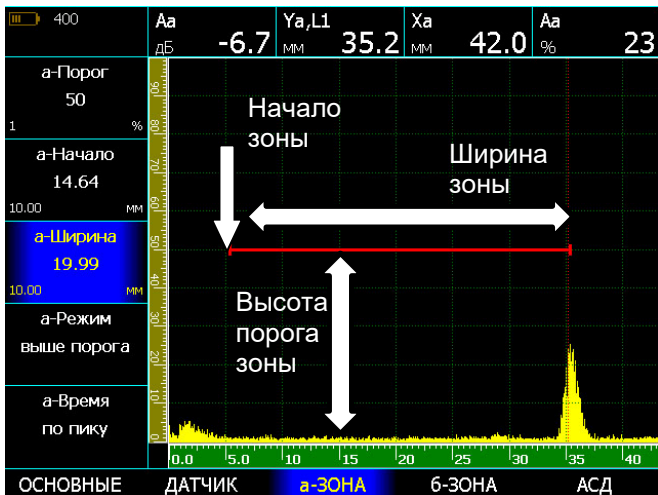
Рис.3-1 Регулировка положения зон контроля (стробов)
