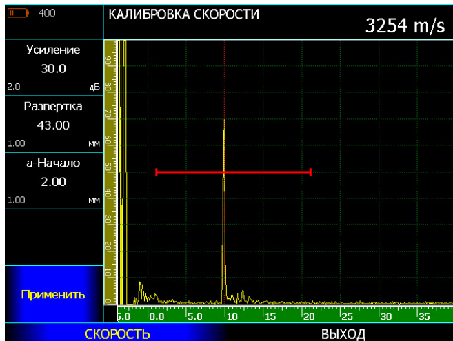
Рис. 3-17 Калибровка скорости УЗК в образце СОП 10,0мм по грани образца
