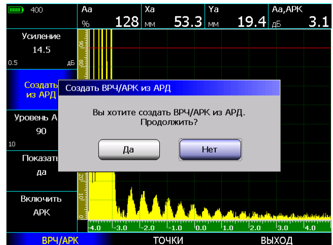
Рис.5-6 Создание кривой ВРЧ/АРК из имеющейся кривой АРД
