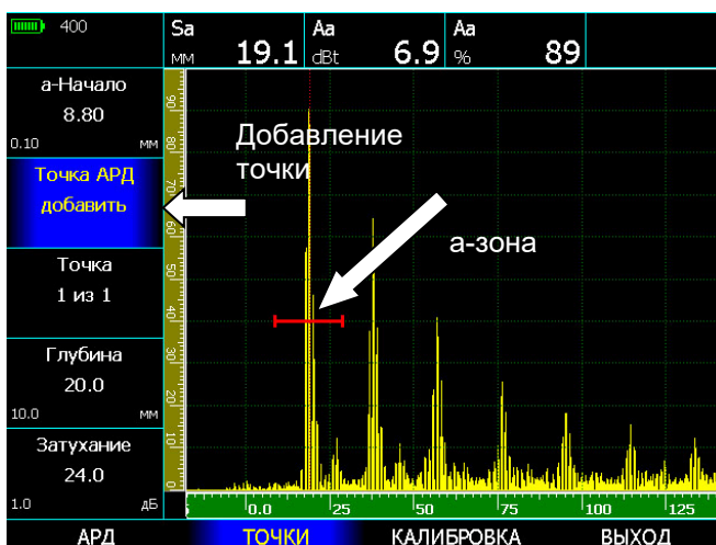
Рис.6-1 Создание зависимости АРД
