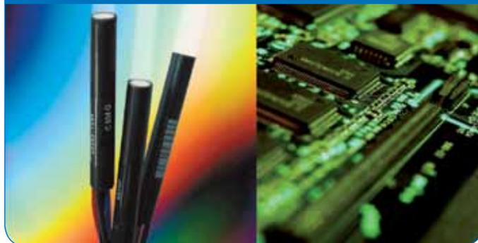
Преимущества канального фотоэлектронного умножителя. Канальный ФЭУ – новый вид детектора, специально разработанного для применения в ОЭ спектрометрии. Канальный ФЭУ имеет существенно более меньшие размеры, чем классические, что позволяет устанавливать по четыре канала на анализ каждого химического элемента.
