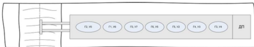
Рисунок 12 - Схема расположения механоакустического блока МАБ1Д относительно сварного шва.
