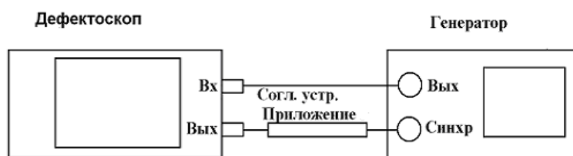
Рисунок 124. Схема для определения диапазона и абсолютной погрешности измерения временных интервалов
