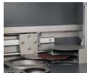
Шаг 4: Следующий MD-расходный материал берется с подъемника и перемещается на MD-Disc
