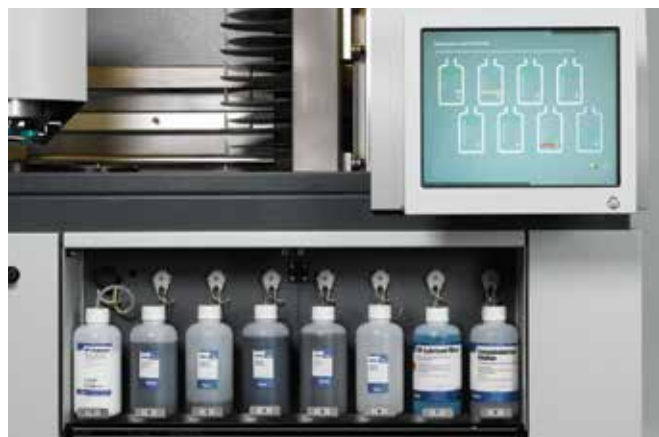
Индикатор всех восьми MD-расходных материалов на экране в одном окне делает их смену легкой и быстрой
