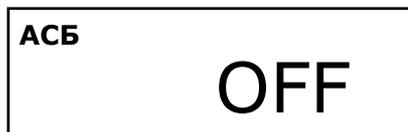
Кнопками изменения значений параметров включаем/выключаем АСБ. При включенной АСБ и выходе измеренного значения за пределы установленных значений максимума и минимума, на индикатор выводится слово «БРАК».
