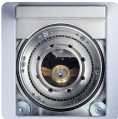
Вращение образцов для точности и воспроизводимости результатов
