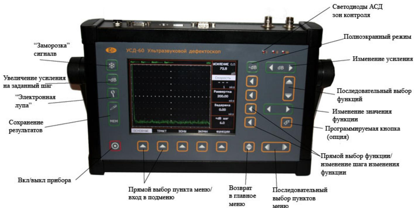
Рис 1-2—Клавиатура дефектоскопа
