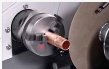
Вращение / осцилляция сокращает время резки и позволяет избежать перегрева твердых материалов
