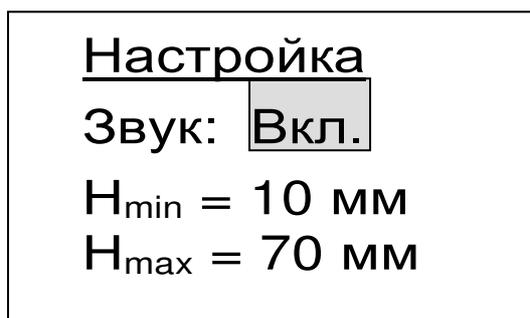
Звуковой сигнал можно включить или отключить, значения  $H_{\min}$  и  $H_{\max}$  устанавливаются в любых рабочих пределах.
