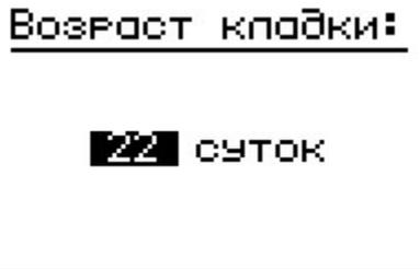
Параметр «Возраст кладки» может изменяться в пределах от 7 до 28 суток с дискретностью в 1 сутки. При 7, 14 и 28 сутках значение поправочного коэффициента  $k_t$  берется из таблицы 1, а внутри этого диапазона производится линейная интерполяция.
