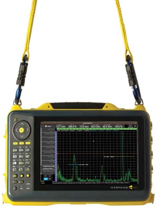
**HARFANG VEO** оснащён двумя независимыми каналами с генераторами по 400 В для работы с стандартными одноэлементными преобразователями на объектах с высоким затуханием или больших толщинах.
