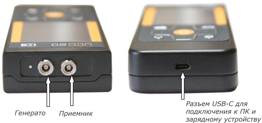
Рис 1-3 Разъемы прибора
