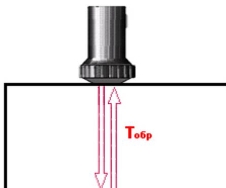
рис.3-6 Калибровка прямого преобразователя
