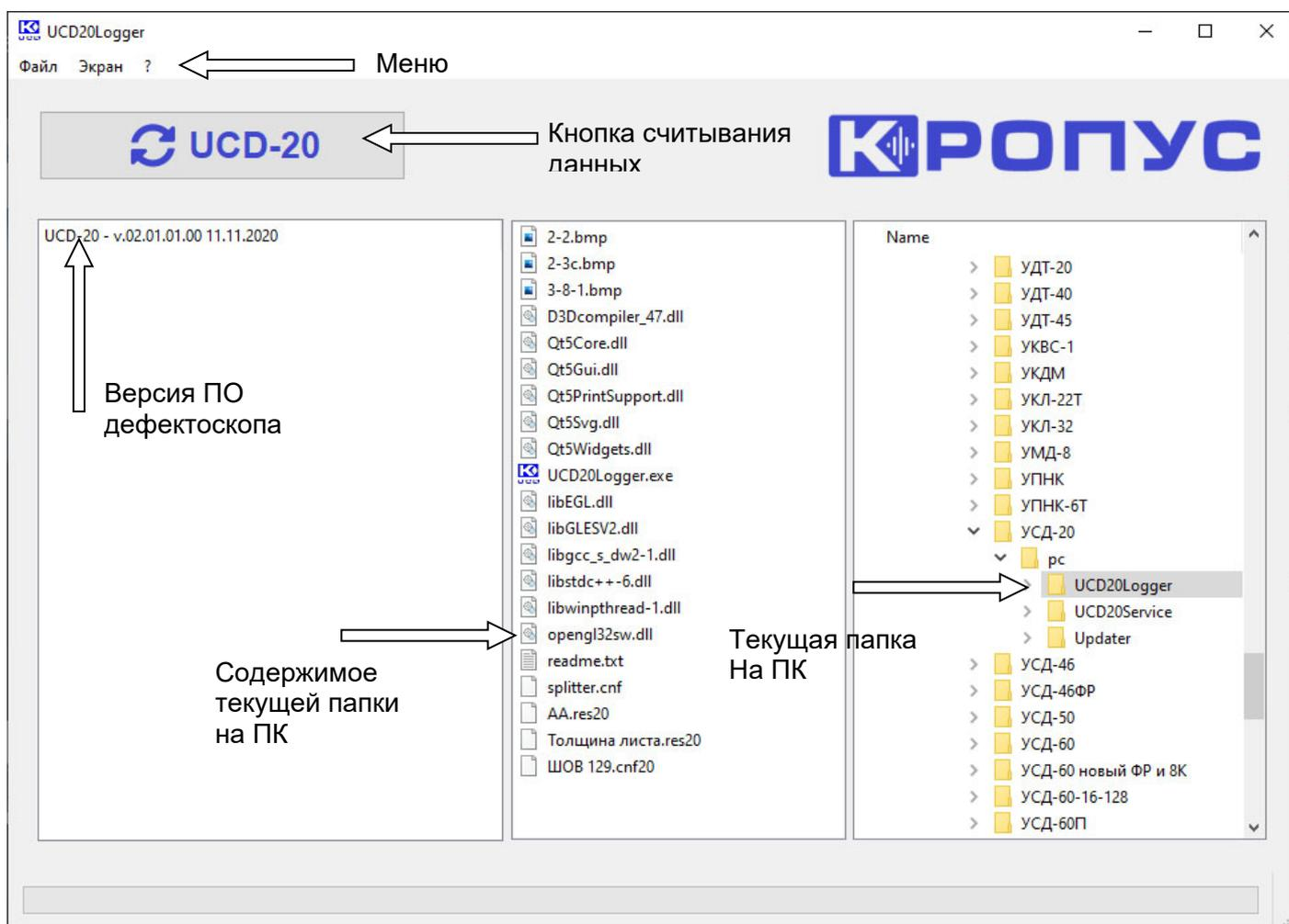
Рис. 5-1 Программа UCD20 Logger
