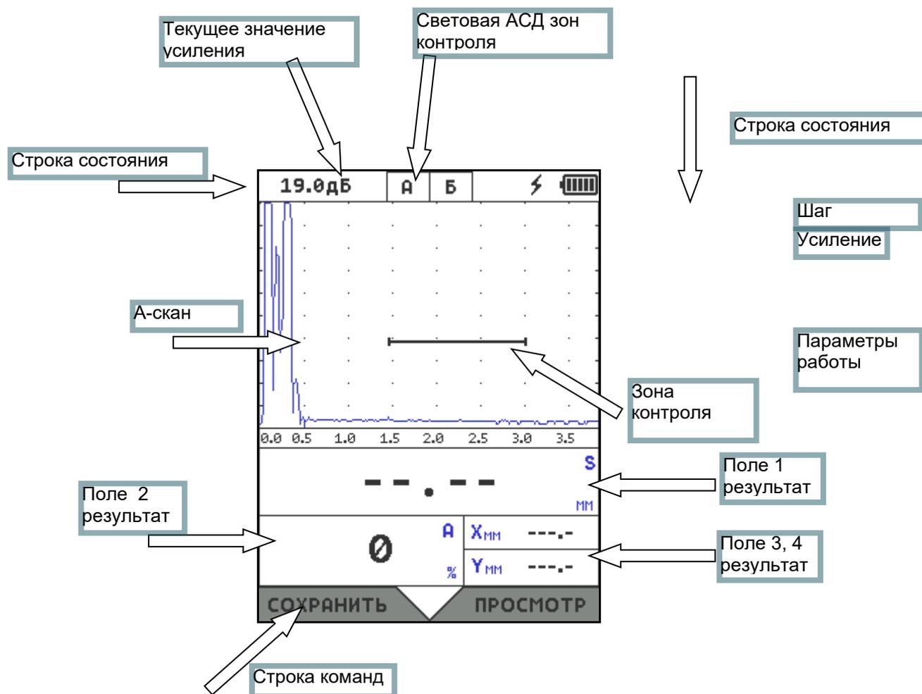
Рис.1-5 Структура экрана дефектоскопа
