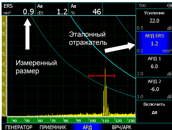
Рис. 6-3 Вычисление эквивалентной площади отражателя
