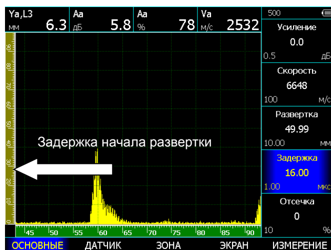
Рис. 2-12 Изменение задержки начала развертки
