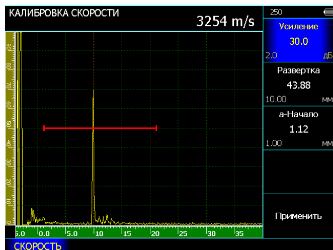
рис. 3-16 Калибровка скорости УЗК в образце СОП 10,0мм по грани образца
