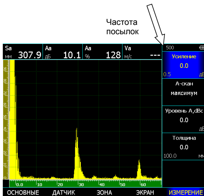
Рис. 2-9 Частота посылок на экране прибора
