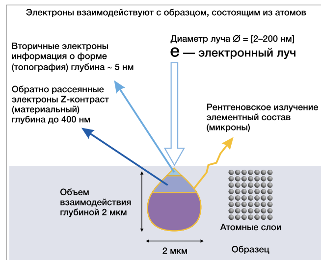
Пространственное разрешение электронов в СЭМ
