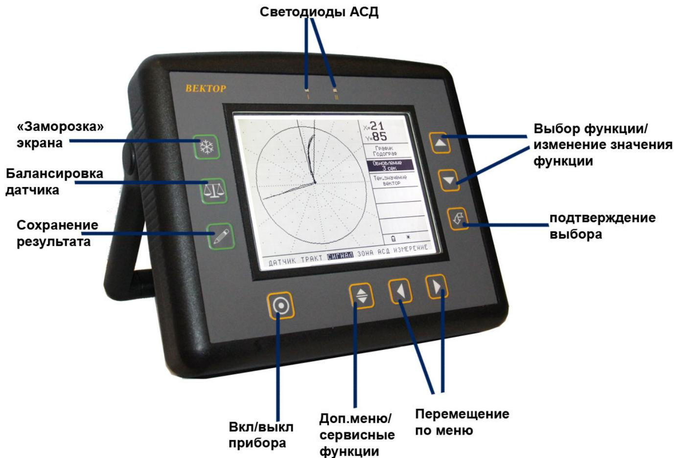
Рис 1-3—Клавиатура дефектоскопа
