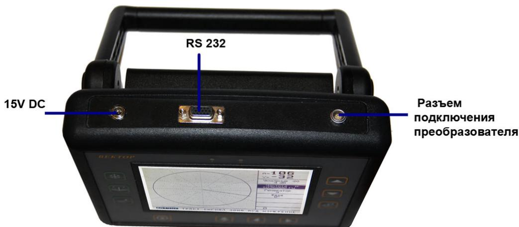
Рис 1-2. Вид прибора сверху
