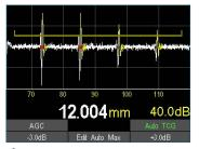
Автоматическая временная регулировка чувствительности (АТСG): в зависимости от времени прохождения сигналов усиление регулируется таким образом, что первые четыре эхо-сигнала усиливаются почти до одинаковой высоты.
