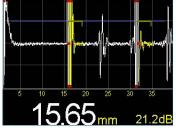
АиtoMax: в некоторых объектах измерений есть мешающие промежуточные и шумовые эхосигналы,препятствующие правильной оценке ультразвукового сигнала. АиtoMax делит исходный диапазон стробирования на две части,определяемые максимальными амплитудами. Таким образом, сигналы вне этих диапазонов стробирования не
