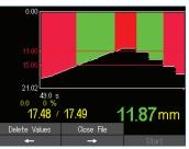
**В-скан**: преобразователь генерирует подробное изображение поперечного сечения области контролируемого материала. Масштабирование дисплея может быть автоматическим или ручным.
